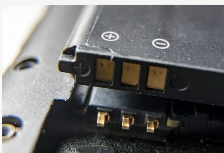
Sind die Kontakte des Akkus verschmutzt oder korrodiert, kann das dazu führen, dass der Laptop nicht mehr startet.
